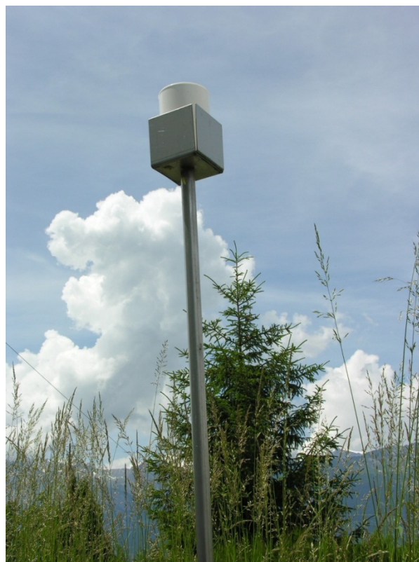
Abbildung 31: Bergerhoff-Gerät für die Staubniederschlagsmessung
