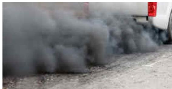
Les gaz d'échappement non épurés des moteurs diesel sont des sources majeures de BC
