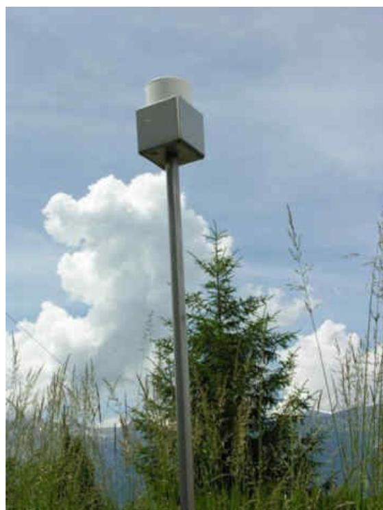
Bergerhoff-Gerät für die Staubniederschlagsmessung
