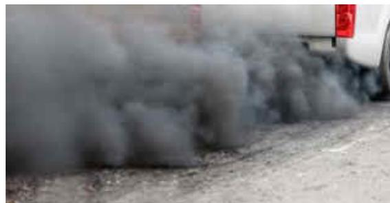
Ungereinigte Abgase aus Dieselmotoren sind grosse BC-Quellen.
