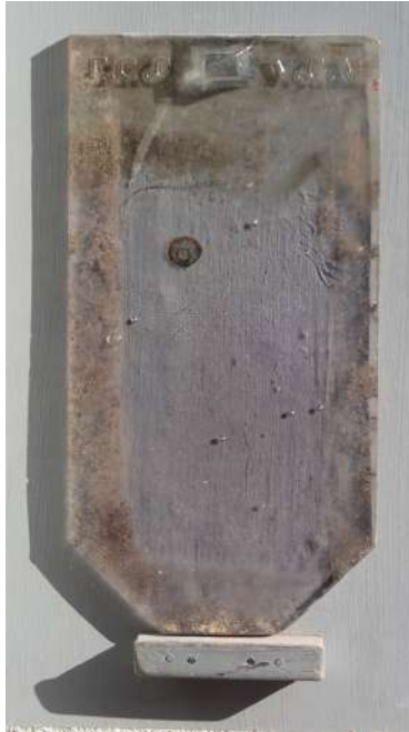
FIGURE 32 – Tuile en verre incolore à pointe portant l'inscription « F. C. C. / V. G. M. » et provenant du château d'Hauteville, vers 1864. (MHA VD 346/48; photo : Michèle Grote, 2022)
