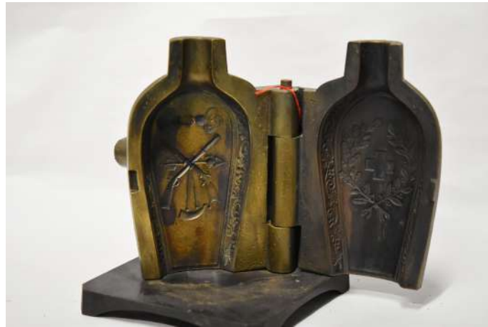
FIGURE 23 – Moule en bronze pour la fabrication des bouteilles de poche « fédérales » n° 87 (1901-1910), premier tiers du XX e siècle, environ 20 cm. (Musée du Vieux-Monthey, MV 486; photo de l'auteur, 2022)
