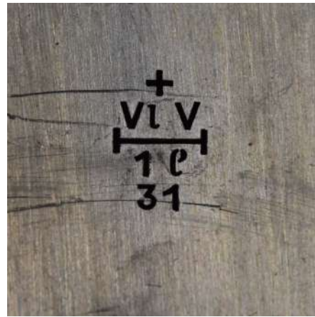
FIGURE 2 – Chablon métallique présentant la marque de vérification de la Verrerie de Monthey pour un contenant d'un litre, 1931. (Archives de l'Etat du Valais, CH AEV, Verrerie de Monthey, G/13, 2025)
