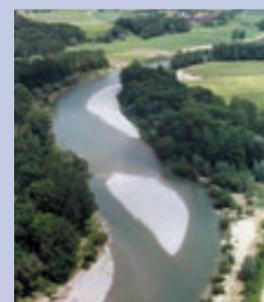
Dieses Bild der jüngst aufgeweiteten Thur zeigt, welche Morphologie die Rhone an den punktuellen Aufweitungen entwickeln könnte.
