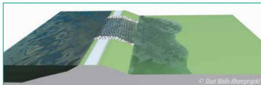
Neben der Sicherung und dem Ausbau der Rhone ist es wichtig, für die extremen Hochwasser, die in ihrem Bett nicht abfliessen können, überströmbare Dämme vorzusehen. Sie halten selbst bei einer Überflutung stand und lassen nur ausserhalb der bebauten Zonen die Wassermengen in die Ebene überquellen, die der Fluss nicht abführen kann. Die Gefahr ist kontrolliert, tritt viel seltener auf und massgeblich reduziert. Die Geschwindigkeit und Höhe des überflutenden Wassers sind wesentlich geringer.
