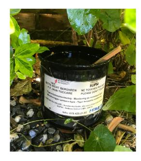
L'ovitrape, un piège pour détecter la présence du moustique tigre. Le piège consiste en un bâtonnet de bois plongé dans un récipient d'eau et sur lequel le moustique dépose ses œufs. Des granulés (*Bti*) sont ajouté à l'eau pour empêcher le développement des larves. Une analyse de œufs en laboratoire permet ensuite de distinguer le moustique tigre des espèces apparentées.
