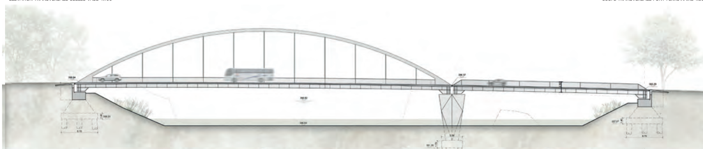
COUPE LONGITUDINALE PONT ROUTIER 1:200
