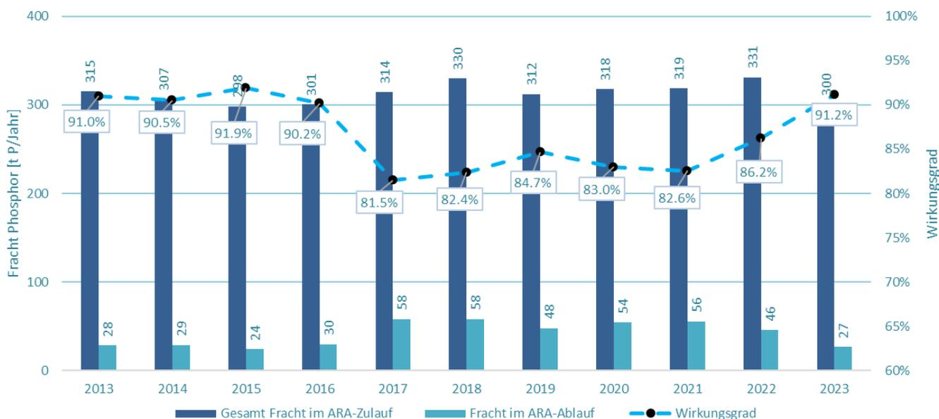
**Abbildung 11: Entwicklung der Phosphor-Frachten und Reinigungsleistungen**
