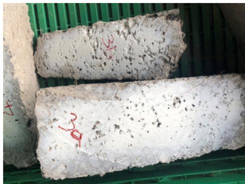
Negative PAK-Marker-Tests (Quelle: Labco, Martigny)
