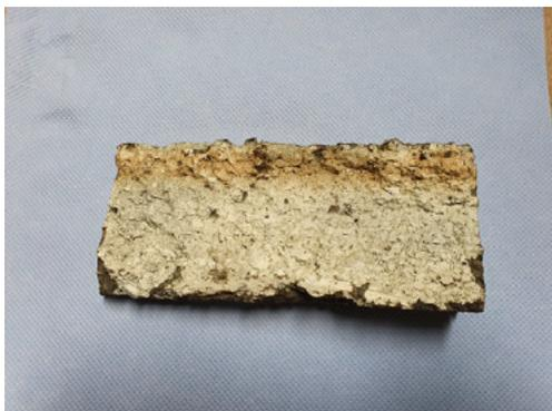
Positiver PAK-Marker-Test (Quelle: Labco, Martigny)
