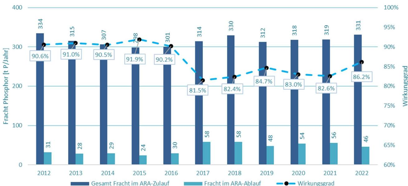
**Abbildung 11: Entwicklung der Phosphor-Frachten und Reinigungsleistungen**
