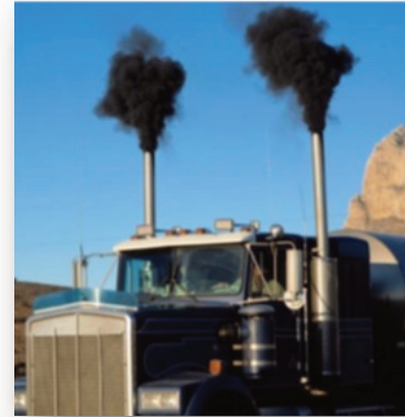
Abb. 18: Ungereinigte Abgase aus Dieselmotoren sind grosse BC-Quellen
