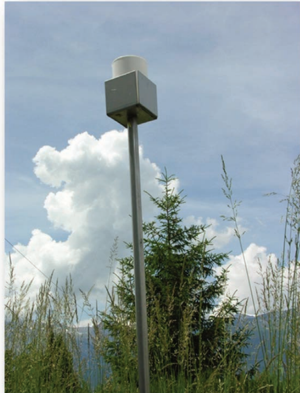
Abbildung 27: Bergerhoff-Gerät für die Staubniederschlagsmessung
