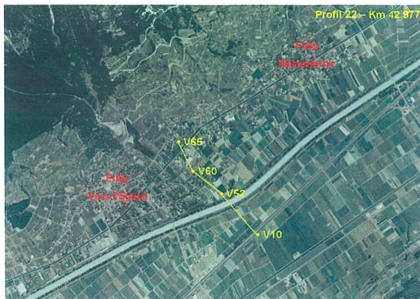
Figure 3a : Plan de situation de la région de Fully, position du Rhône, du canal et des piézomètres Source : projet Rhône.
