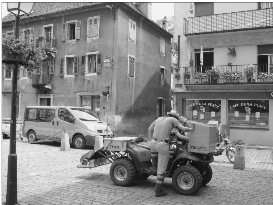
Fig. 11 – Saint-Maurice, place du Parvis. Engin utilisé pour procéder à la prospection géoradar de la Place du Parvis.
