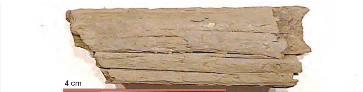
FOR 15/27-2 Larix / Picea Foto 67 Rundstab, ovaler Querschnitt, aus Stammholz
