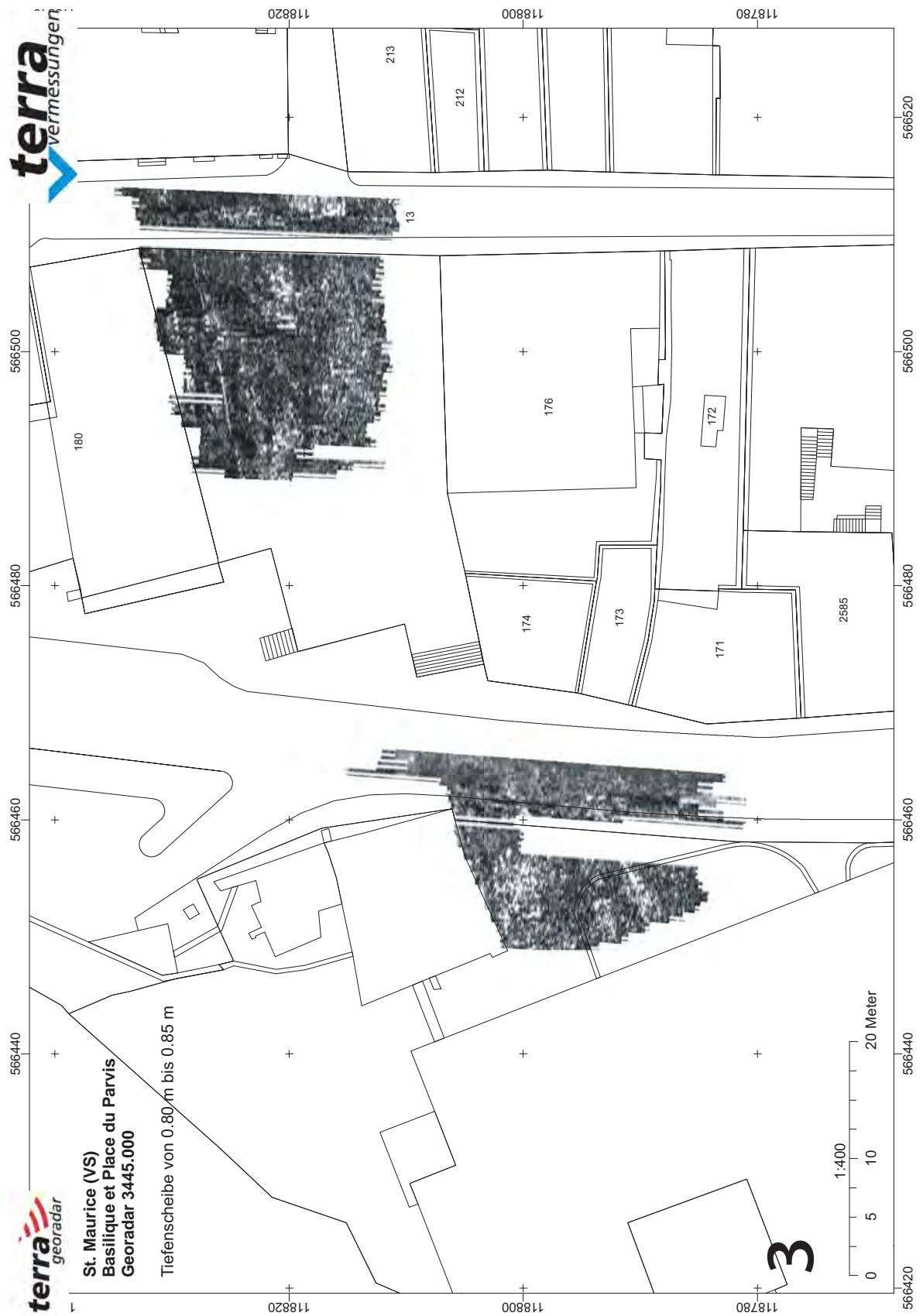
Fig. 14 Exemple de mesures géoradar effectuées à 0,8 m sous la surface du sol actuel (TERRA Vermessungen, Zürich).
