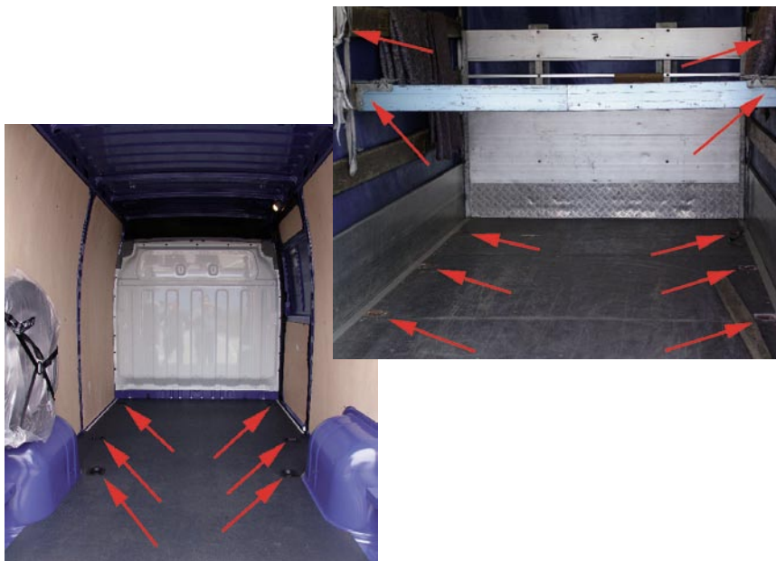
Accessoires et points d'ancrage permettant d'arrimer le chargement
