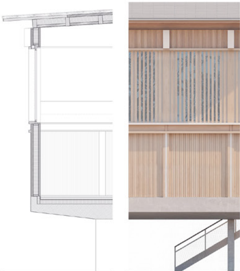
Fassadenchnitt mit Ansicht 1:50
