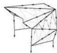
chemins des forces en compression dans les poutres de bord et en traction/compression dans les boîtes intérieures
