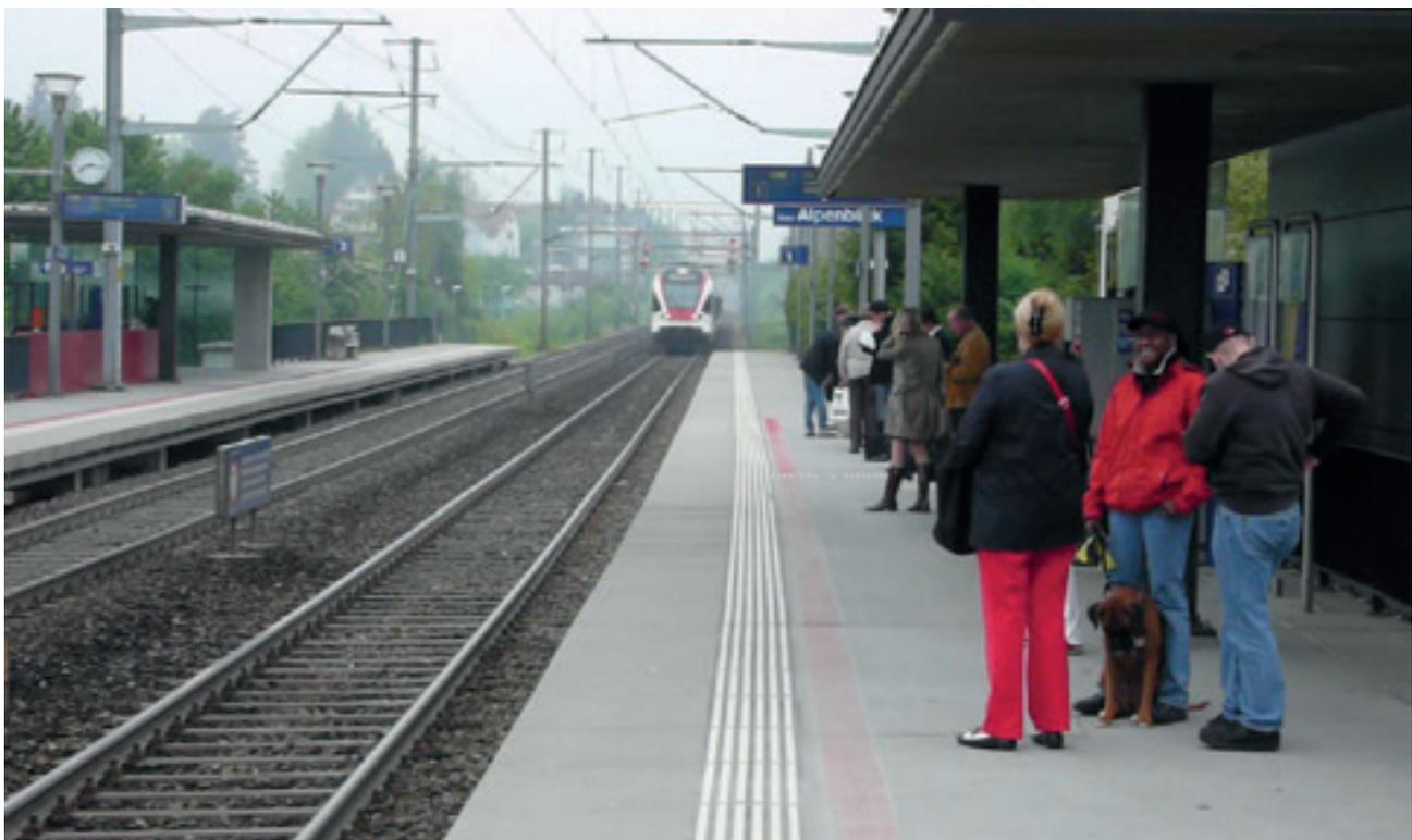
Figure 5 – Gare d'Alpenblick : dimensionnement généreux des quais (3.00 m) permettant une bonne gestion des flux
