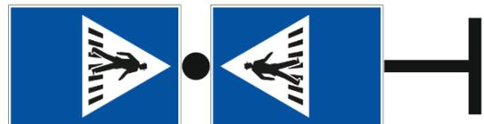
Für jeden Signalstandort wird zusätzlich der **Typ des Signalträgers** symbolisch auf dem Plan eingezeichnet. Die Signalträger werden direkt unterhalb des letzten Signals mit schwarzen Linien dargestellt. Unterhalb des Signalträgers wird der Signalfuss ebenfalls mit einer schwarzen Linie angedeutet (Winkel von 90° zum Signalträger).
