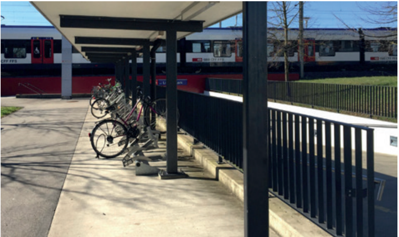
Figure 12 – Gare de Lindenpark : stationnement vélo sécurisé et protégé avec accès direct aux liaisons verticales (escalier et rampe) d'accès aux quais
