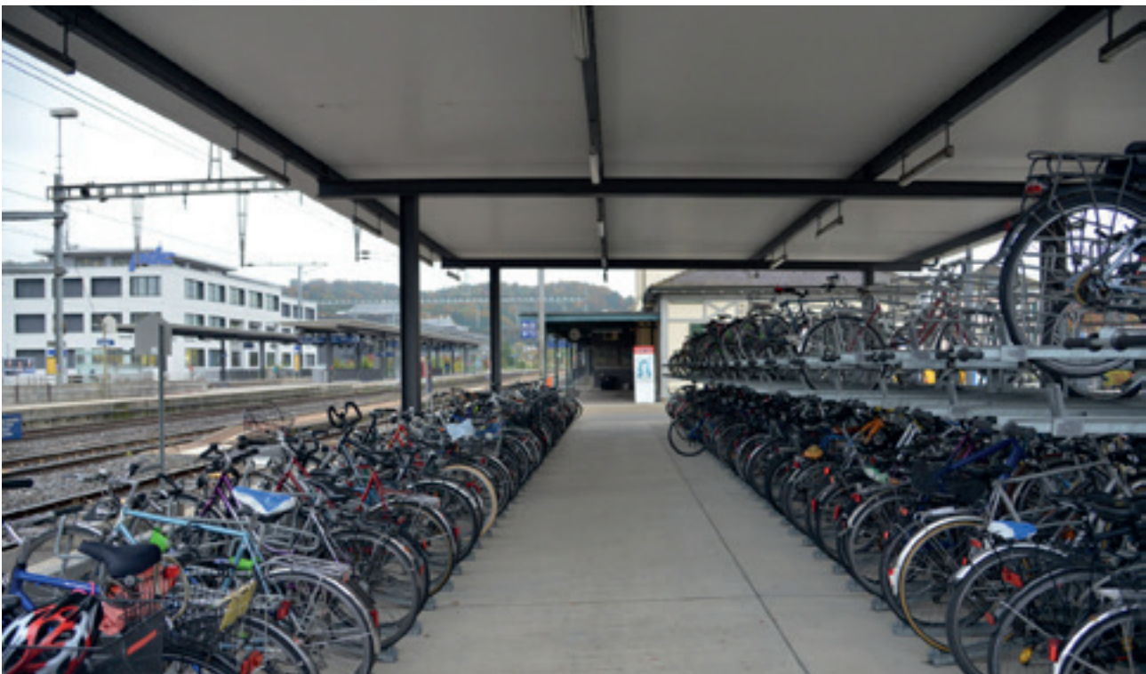
Figure 13 – Gare de Wettingen : stationnement vélo sécurisé et protégé sur le quai et au contact direct du bâtiment de gare ; les étriers de roue ainsi qu'un élément physique (muret) assurent la séparation physique entre le quai et le stationnement vélo.
