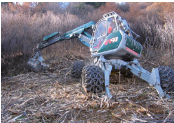
PHOTO 34 Travaux de giro- broyage en vue d'améliorer l'habitat du tétrasyre, ici complètement co- lonisé par l'aulne vert (Thyon).
