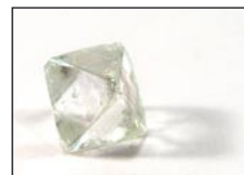
Un diamant est composé uniquement de carbone. Voici un magnifique exemple de diamant brut dans sa forme naturelle de cristal octaèdre.
