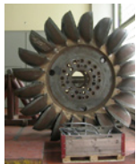
So gross ist eine Pelton-Turbine
