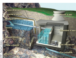
Captage de source
