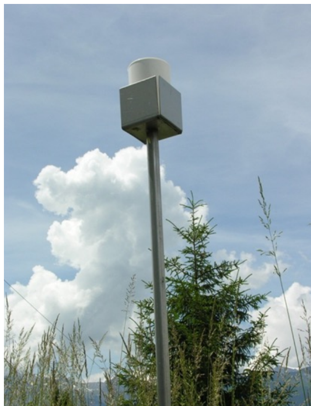
Bergerhoff-Gerät für die Staubniederschlagsmessung
