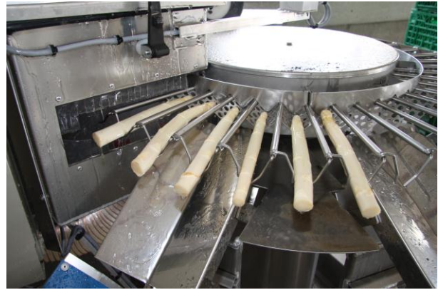
Photo 2: Les asperges coupées et lavées tombent dans 3 réceptacles selon leur calibre.
