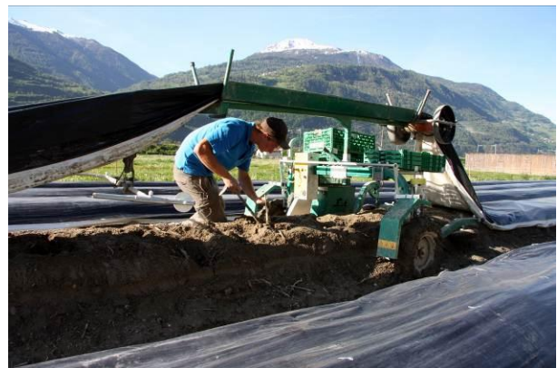
Photo 1 : Machine électrique Bagioni d'assistance à la récolte de l'asperge - Châteauneuf -SCA
