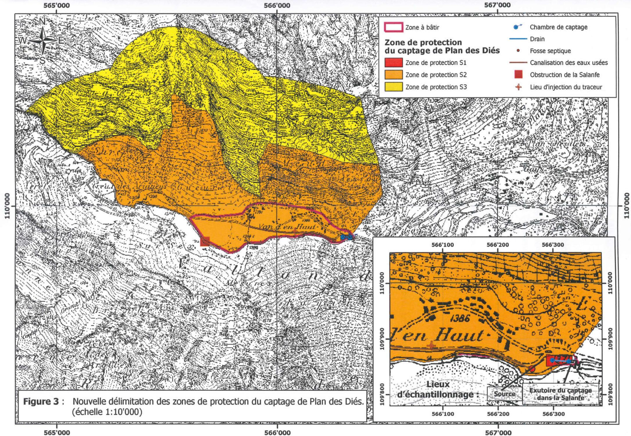
**Figure 3 :** Nouvelle délimitation des zones de protection du captage de Plan des Diés. (échelle 1:10'000)
