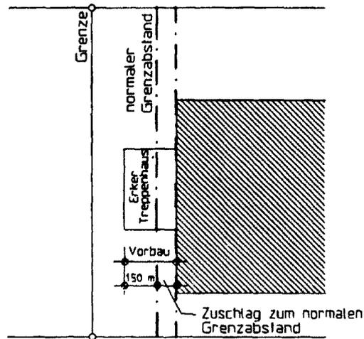
Abb. 3: Grenzabstand bei auskragenden Bauteilen grösser als 1.50 m
