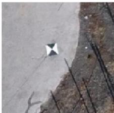
Die Verteilung der Passpunkte muss im Verhältnis zu den geplanten Fluglinien optimal sein, um das gesamte Projekt abzudecken. Es ist wichtig, dass die Punkte nicht alle auf der gleichen Längsachse liegen, da sonst die Gefahr besteht, dass sich das Projekt etwas um diese Achse dreht.
