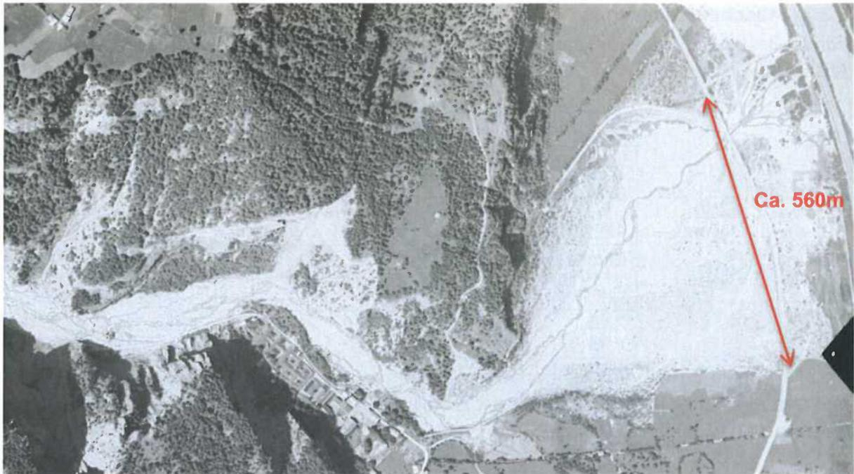
Abbildung 12: Historisches Luftbild Gamsa aus dem Jahr 1943 (Quelle swisstopo). Das Luftbild zeigt, dass sich die Gamsa natürlicherweise im Mündungsbereich ausdehnte (Geschiebeablagerung). Deshalb gilt es in diesem Gebiet, sofern möglich, einen breiteren Gewässerraum auszuscheiden.
