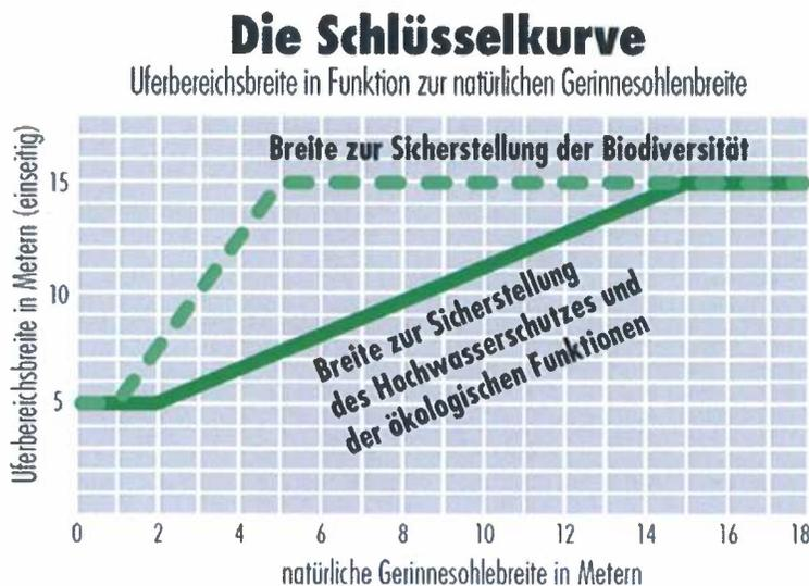
Abbildung 3: Schlüsselkurve, die zur Erstellung der Formeln zur Berechnung des Raumbedarfs für Fliessgewässer in der GSchV gedient hat.
