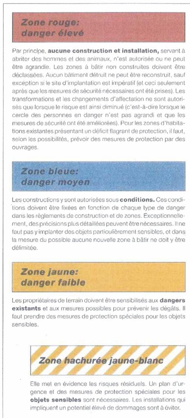
Figure 2 : Signification des degrés de danger selon l'OFEV (1997).
