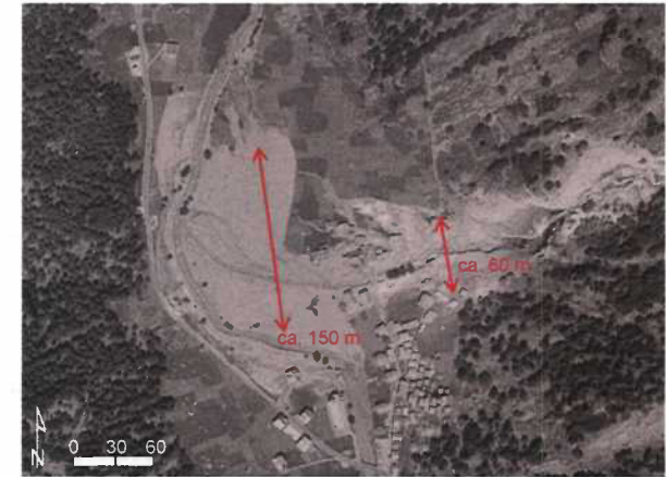
Abb. 20 Ausschnitt des Kegelbereichs des Fellbachs aus dem Luftbild 1968 (Quelle: map.geo.admin.ch) mit Erosionen und Murgangablagerungen vom Ereignis 02.07.1968 [4].
