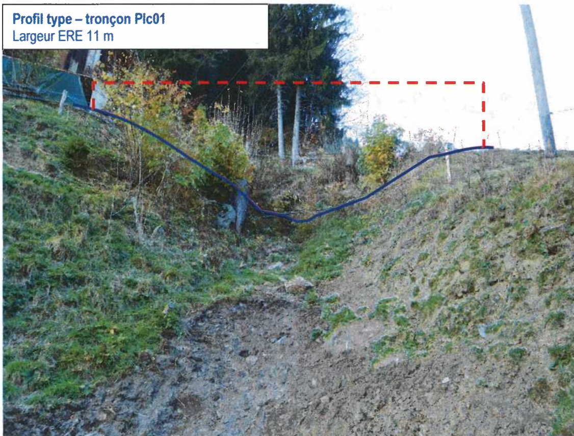
Profil type – tronçon Pra 01 Largeur ERE 11 m
