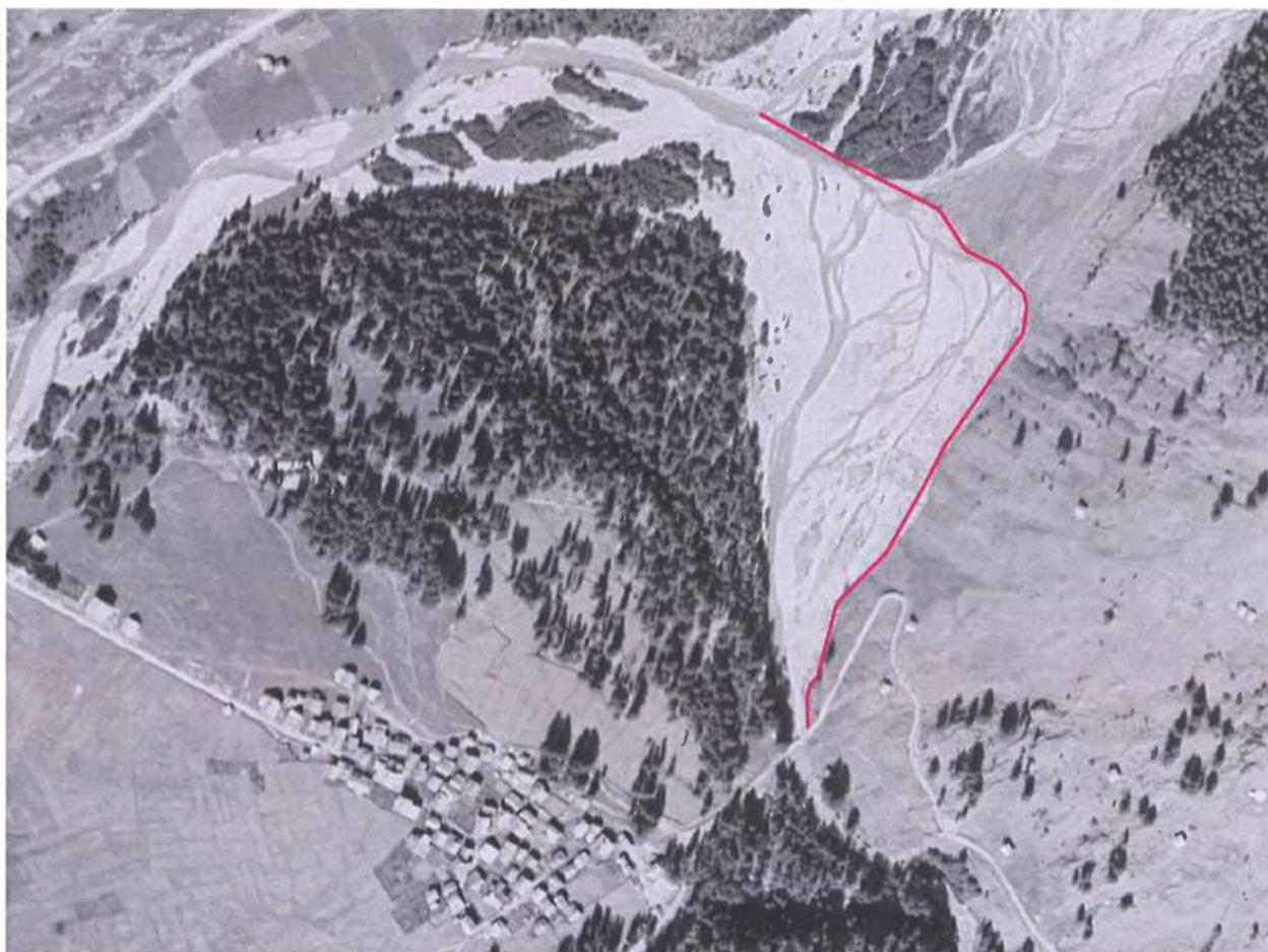
Abbildung 17: Goneri-Delta, Luftaufnahme vom 14.09.1941, swisstopo mit eingezeichnetem rechtsufrigem Rand der Pendelbreite
