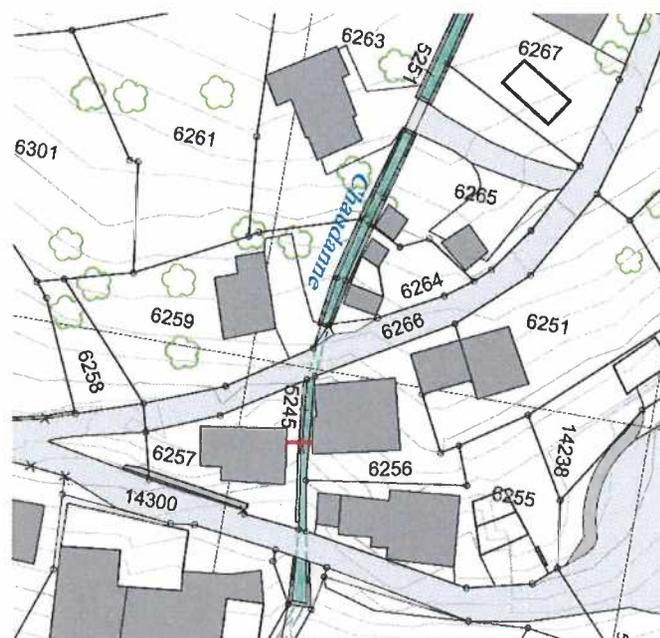
Figure 4-6: Traversée de Montagnon par le torrent de Chaudanne (le trait rouge cote une distance de 3 m entre les deux bâtiments)
