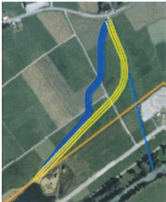
Abb. 16: Varianten Niderbach zwischen Kantonsstrasse und See (orange = ARA-Leitung, blaue Linie = altes, bestehendes Rohr)
