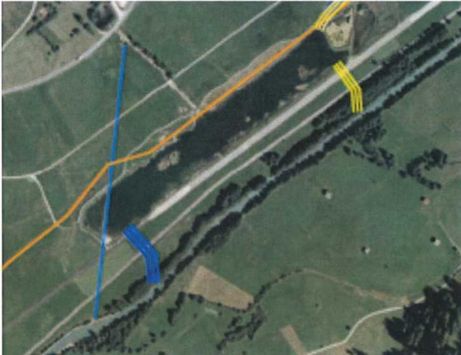
Abb. 17: Varianten Seeabfluss (orange = ARA-Leitung, blaue Linie = altes, bestehendes Rohr)
