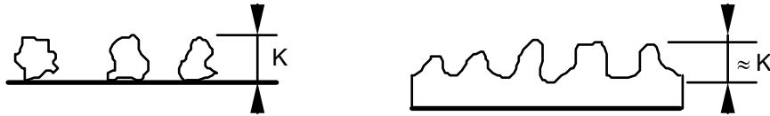
Fig. 2.2 Définition de la hauteur de sable équivalente K pour mesurer la rugosité d'une paroi
