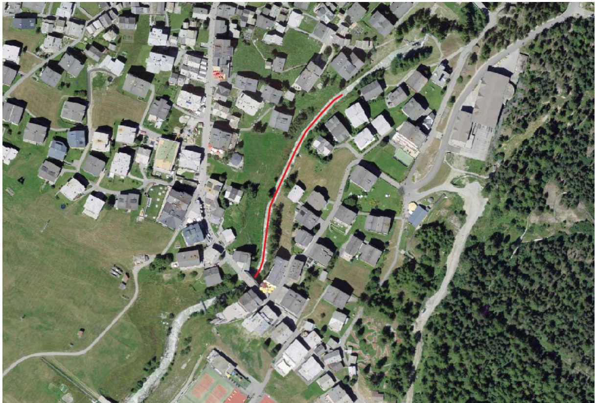
Abbildung 35: GIS-Ausschnitt der als ein Objekt erfassten Schutzbauten Schwellen Feevispa (rote Linie)
