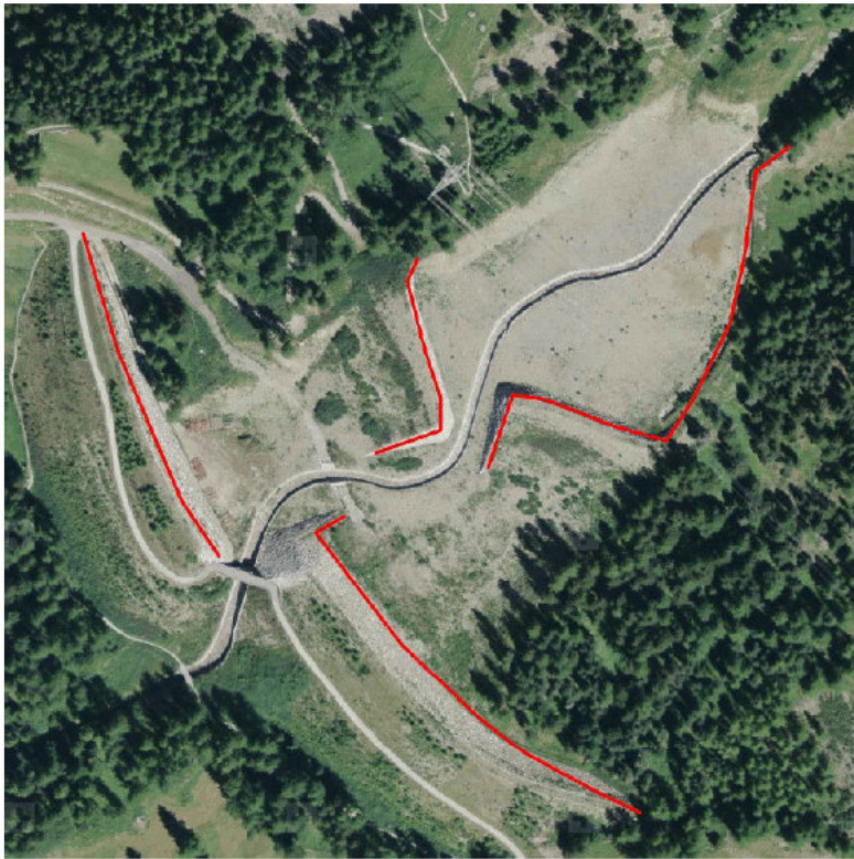
Abbildung 4: Beispiel eines Schutzbauwerks bestehend aus mehreren Geometrien desselben Typs (Multigeometrie), Bsp.: Auffangwerk für Lawinen aus Dokumentation zum Datenmodell Schutzbauten Naturgefahren des BAFUs.
