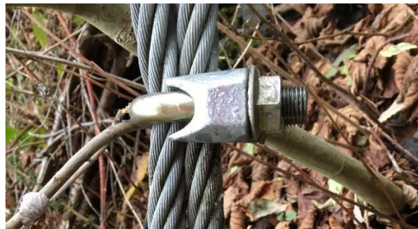
Figure 5: Serrage requis pour un serre-câble lubrifié taille 16 qui a été serré avec 49 Nm d'après EN 13411-5.
