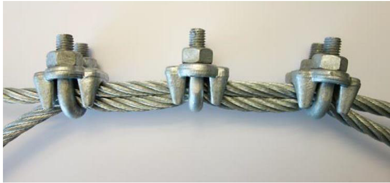
Figure 2 : Serrage des câbles après installation avec le couple de serrage prescrit d'après FF-C-450 Type 1 Classe 1 du Geobrug System Manual 250-N-FO / 07.
