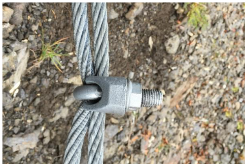
Figure 4 : Serrage requis pour un serre-câble lubrifié taille 16 qui a été serré avec 49 Nm d'après EN 13411-5.
