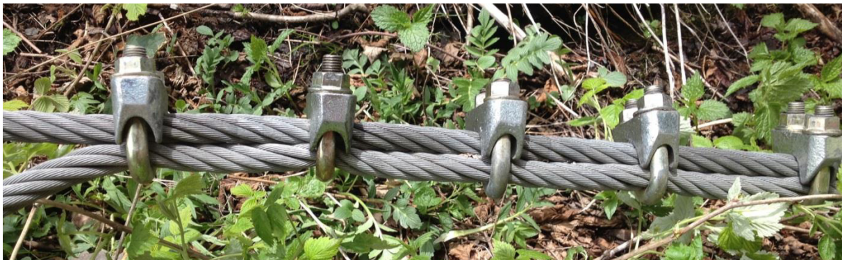
Figure 3 : Deux serre-câbles de gauche avec un couple de serrage correct montés sur des pièces lubrifiées à des fins de contrôle, comparé aux trois serre-câbles de droite dans leur état d'origine sans serrage de câble visible.
