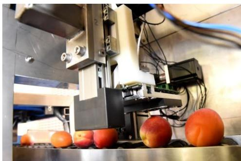
Module de mesure de l'indice de maturité (IDA) du prototype Agrimat-Sintéléia
