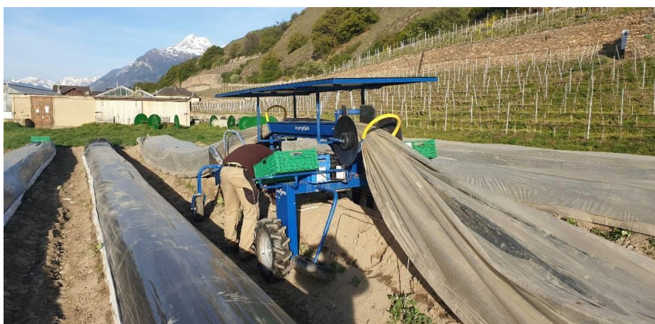
Machine d'assistance à la récolte des asperges avec panneaux photovoltaïques
