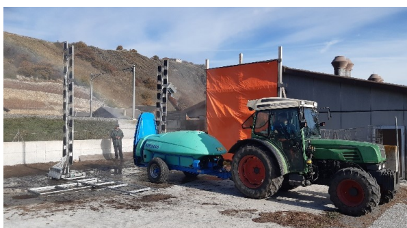
Test de la répartition du produit lors des contrôles 2020 à Châteauneuf
