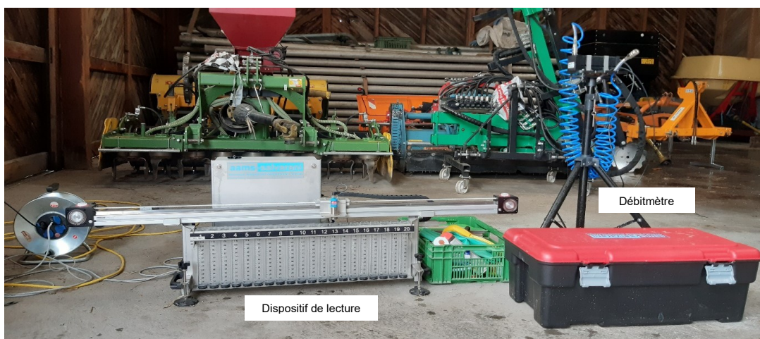
Dispositif de lecture (gauche) et débitmètre (droite) de AAMS Salvarani
