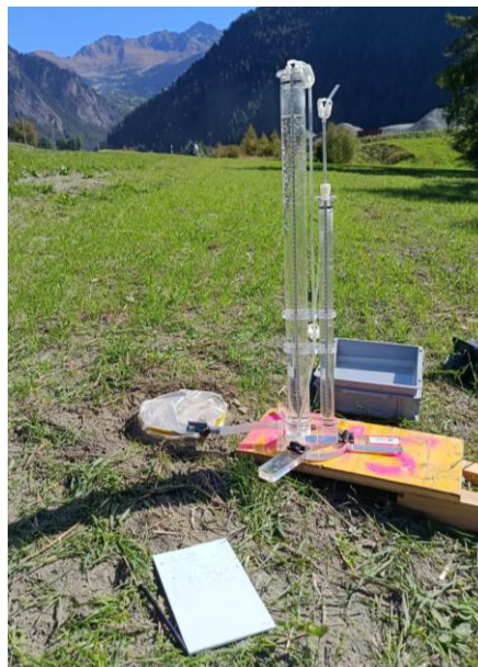
Test d'infiltration dans la couche supérieure du sol sur un site témoin dans le Val de Bagnes
