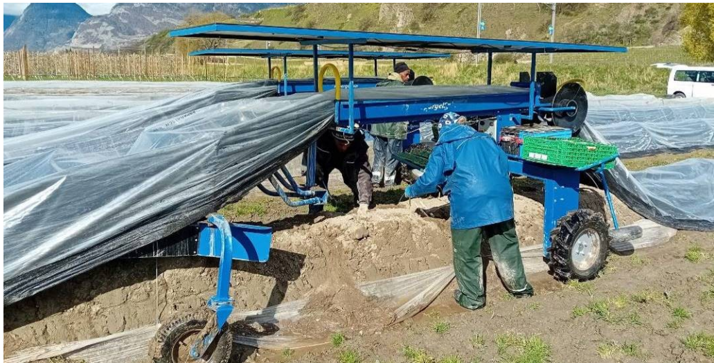
Récolte d'asperges de la variante 2, mini-tunnel avec arceau et film double, avec machine d'assistance Engels®.
