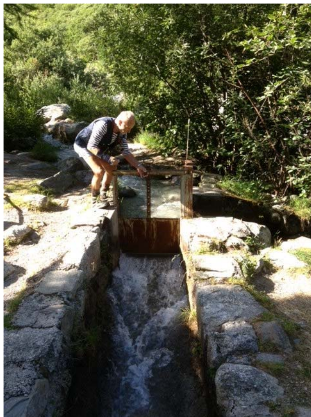
Photo n°2 - Réglage de l'écluse par le garde du bisse
