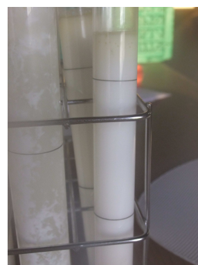
Analyse de la qualité des laits : lactofermentateur
